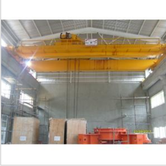
Ray Üzerinde Yürütülen Halatlı ve Elektrik Kumandalı Santral Vinçi
