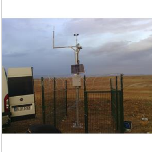
Beton Altyapı Gerektirmeyen Güneş Ölçüm İstasyonu
