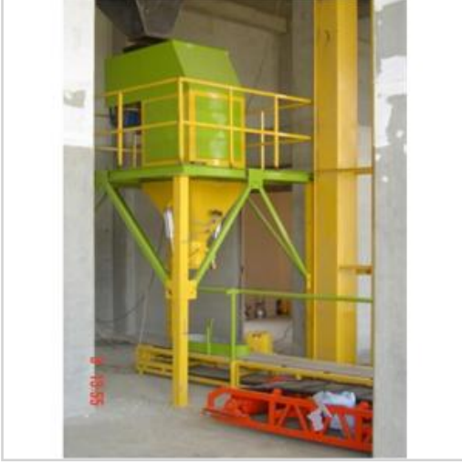
Toz Ya da Taneli Ürünlerin Tartılmasını Ve Paketlenmesini Sağlayan Torbalama Kantarı
