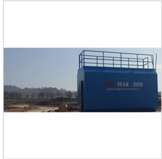
Paket Evsel Atıksu Arıtma Tesisi
