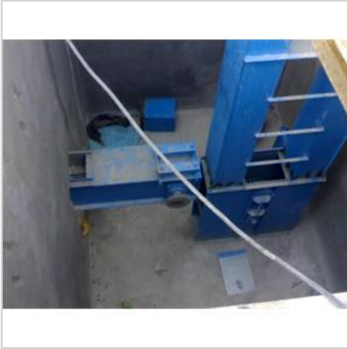
Yem Ve Gübre Gibi Maddelerin Dikey Olarak Taşınmasını Sağlayan Elevatör
