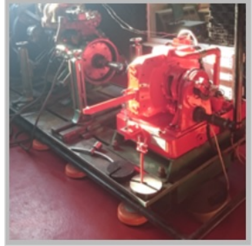
Motor İle Dinamometrenin Oturacağı Ortak Şaseyi Oluşturan Test Sistemi Taşıyıcı Ana Şase
