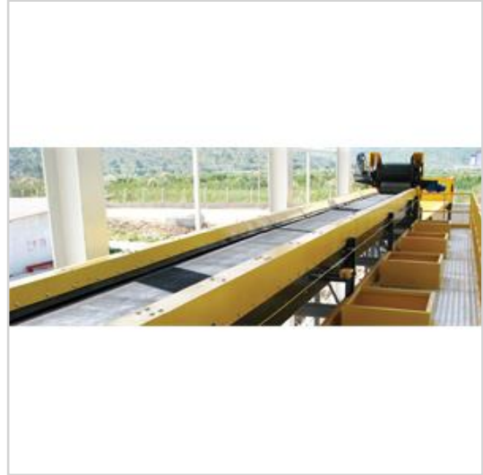
Atıkların Ön Ayrıştırması İçin Kullanılan Atık Ayrıştırma İmha Sistemleri
