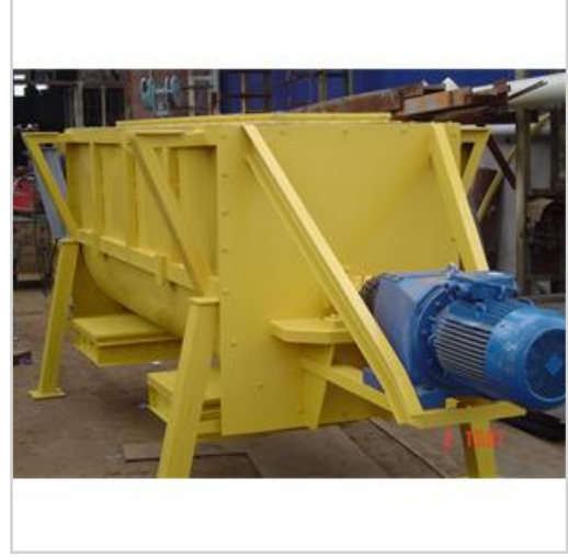
Hammaddelerin Homojen Olarak Karışımını Sağlayan Karıştırıcı Ve Karıştırıcı Ünitesi
